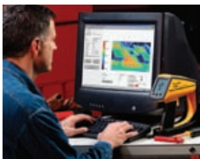
Descargue imágenes y datos al software InsideIR de Fluke para análisis e informes.
